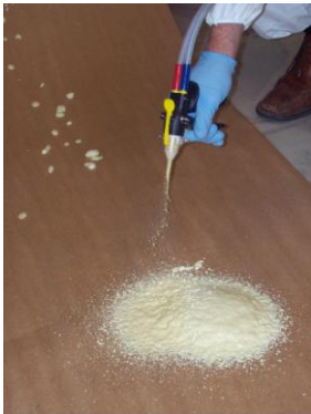
Kun vaahto alkaa roiskia, on vaahtosäiliöt tyhjä. Vaahto värjäytyy valkoiseksi tai tummaksi. LOPETA vaahdotus.
