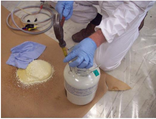
Kun säiliö on paineeton, tee siihen reikä erityiseen "turvallisuusventiliin" vasaralla ja ruuvimeisselillä.
