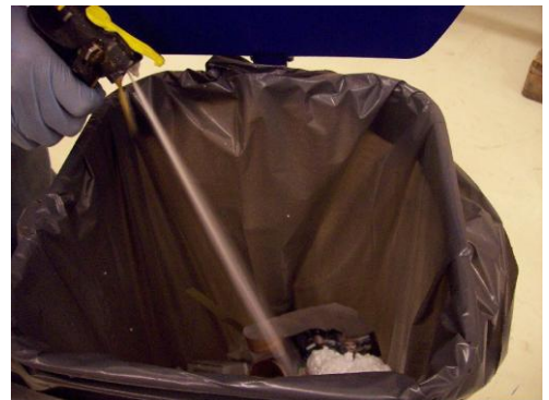
Vapauta kaikki vaahto/paine ruiskupistoolista! Tee tämä roskasäkkiin ilman suutinta.
