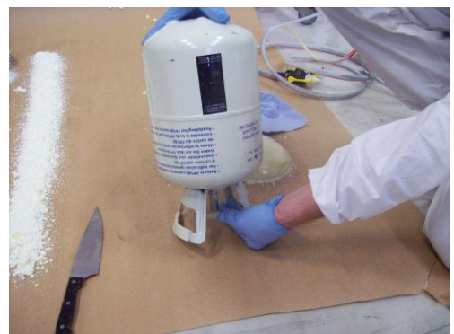
Käännä kumpikin säiliö ja avaa venttiiliä varovasti. Ensin vähän tuotetta tulee ulos kun loppu nitrogeeni tulee ulos. Tämä vie noin 30 sekuntia.
